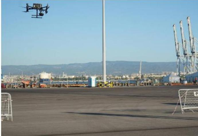
El mayor dron, el Mavic 300 RTK, viene equipado con cámaras de visión en alta definición e infrarroja, así como última tecnología en sistemas de control y mando del equipamiento.
